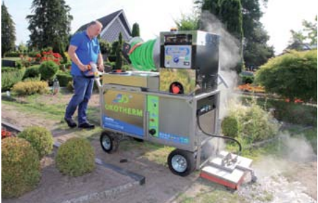
Autarke Maschine in kompakter Bauweise zur Wildkrautbekämpfung – stadiko „Ökotherm“.
