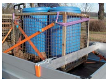
Flüssigkeiten in mobilen Tanks müssen formschlüssig mit dem Fahrzeug verbunden werden. Werden die Tanks in Gitterboxen transportiert, können sie auch durch direktes Verzurren gesichert werden. Foto: SVLFG
